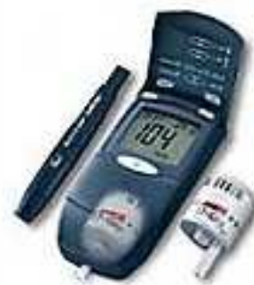
Abbildung 4: Blutzuckermessgerät, Stechhilfe und Messstreifentrommel
